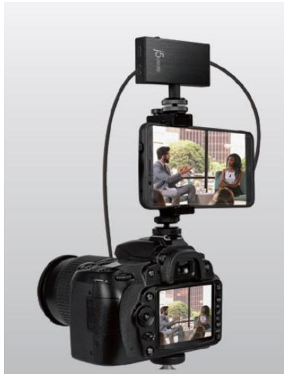
本体のコールドシューアダプターに接続できる 1/4"ネジ用接続ポートを別途販売しております。1/4"ネジ用接続ポートを使用すると JVA02 をカメラのシューマウントとして接続が可能です。
