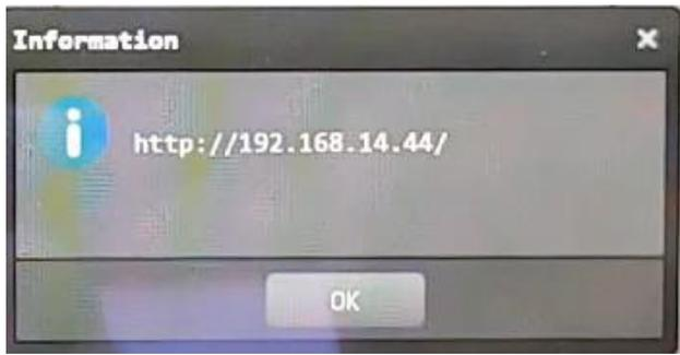
操作しているデバイスがすでに IP を取得していることを確認した後で、ok を押します。管理ページが新しい IP に再接続します。
